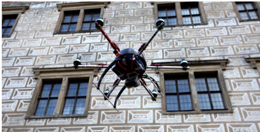
Dálkově řízený vrtulník – hexakopter dokumentoval fasády zámku v Litomyšli.
